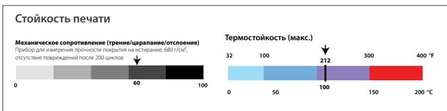
Оценка экспертами Videojet установленной производительности риббона для шероховатых поверхностей при оптимизированных настройках принтера и датчиков.
